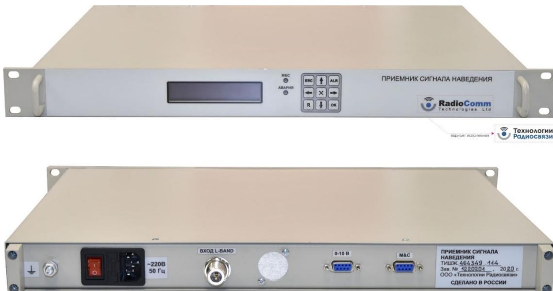
Рисунок 1.2.9 – Приемник сигнала наведения.
