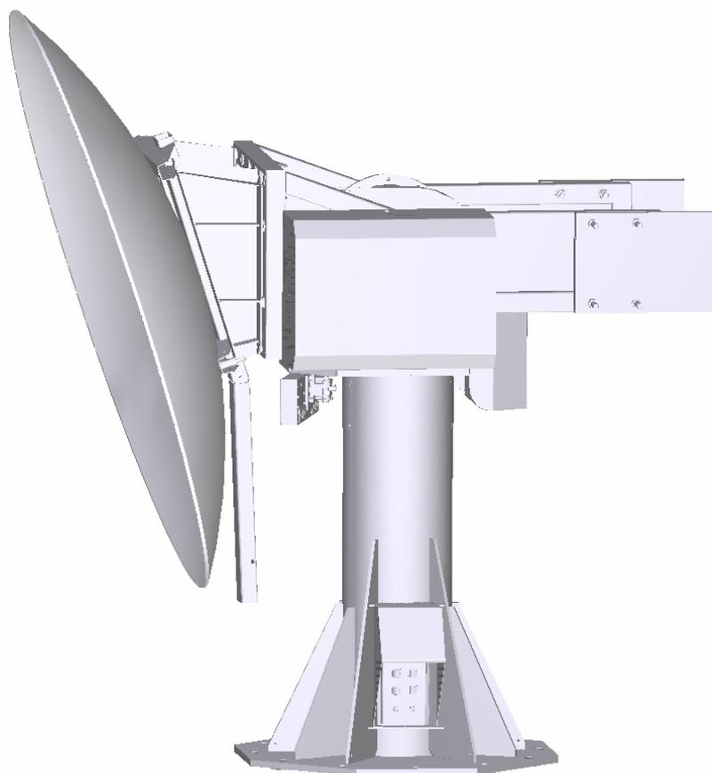
Рисунок В8 – Монтаж средней части кронштейн
